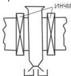
Рис.4. Электромагнитный анализатор с инфранизкочастотным модулятором (ИНЧМ) в виде вращающегося трансформатора.
